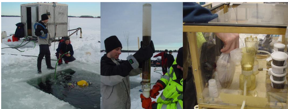
Figur 7: Provtagning från is och porvattenextraktion i argonfylld låda
