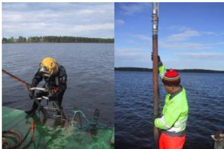
Figur 4: Sedimentkartering utförd med hjälp av dykare och plexiglasrör.
