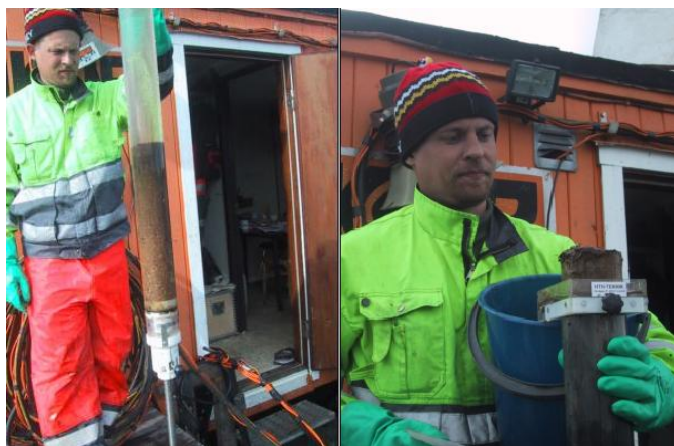
Figur 6: Sedimentprovtagningsröret och skivningsutrustningen.
