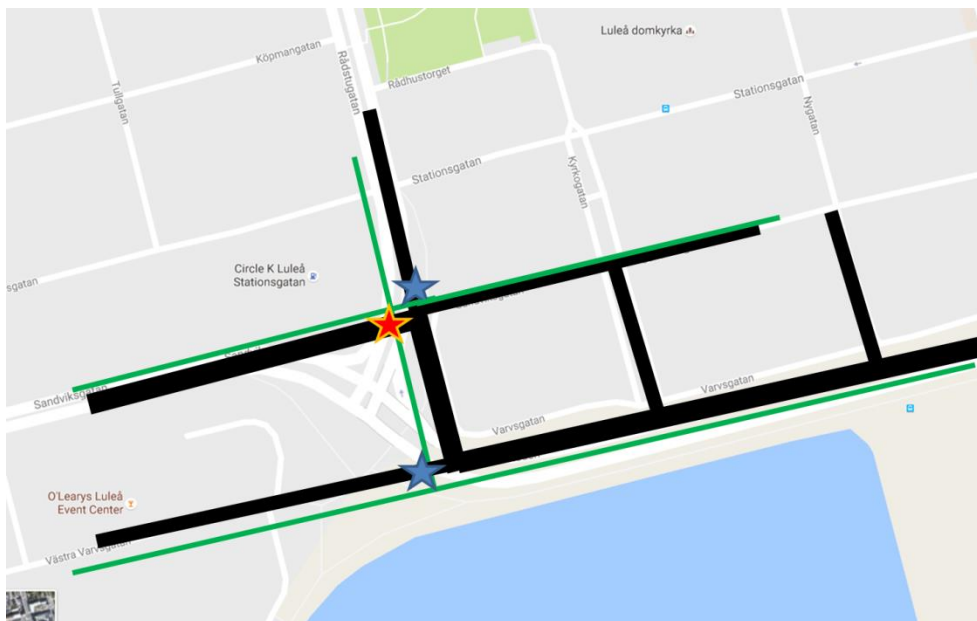
Figur 12. Möjligheter finns att skapa ett gent och sammanhängande cykelnät med relativt få stora korsningspunkter med biltrafiken. Blått markerar korsningspunkter där cykeltrafiken prioriteras, rött markerar punkt som kan bli problematisk.
