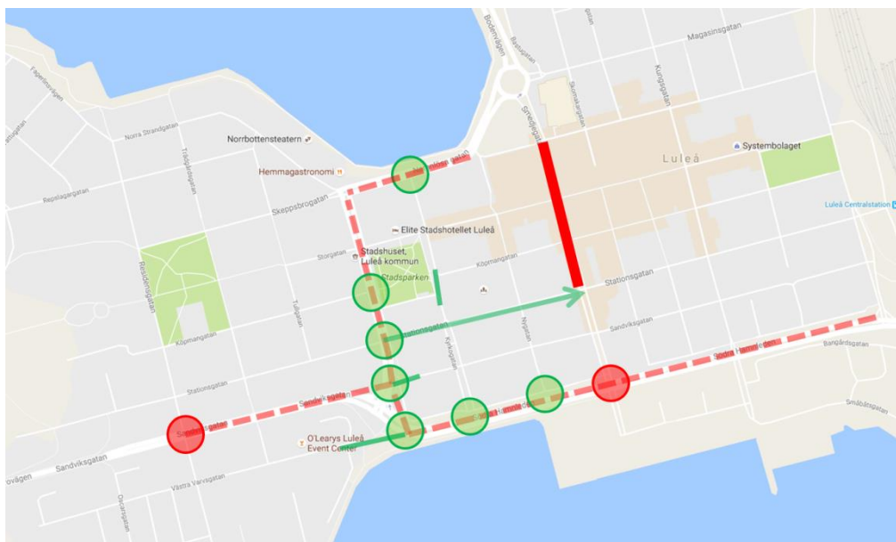
Figur 2. Åtgärder som prövas i Scenario Rutnät. Rött heldraget är stängd gata, rött streckat är minskat antal körfält, röd ring är minskad kapacitet i korsning, grön ring är öppnad korsning, grönt heldraget är öppnad väg.
