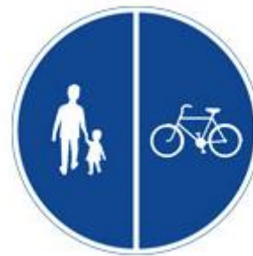
Figur 25. Vägmärke D7 Påbjudna gång- och cykelbanor.
