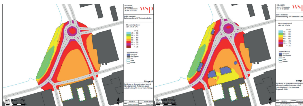
Figur 40 Beräknade maximala ljudnivåer för nuläge till vänster och planförslag prognosår 2040 till höger (WSP, 2022).
