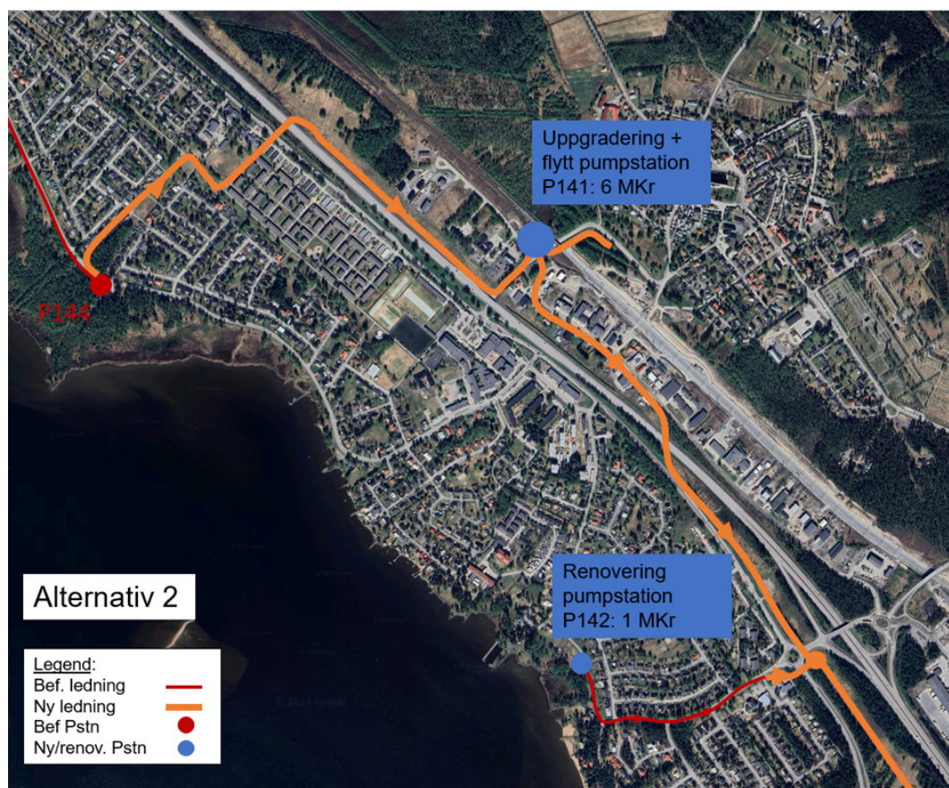
Figur 2. Åtgärdsöversikt på ledningar och pumpstationer för alternativ 2
